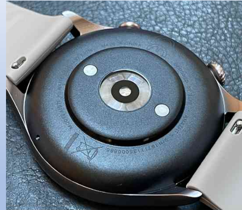
Auf der Rückseite sind die beiden Ladkontakte und Sensoren zur Überwachung der Vitalfunktionen zu sehen.
